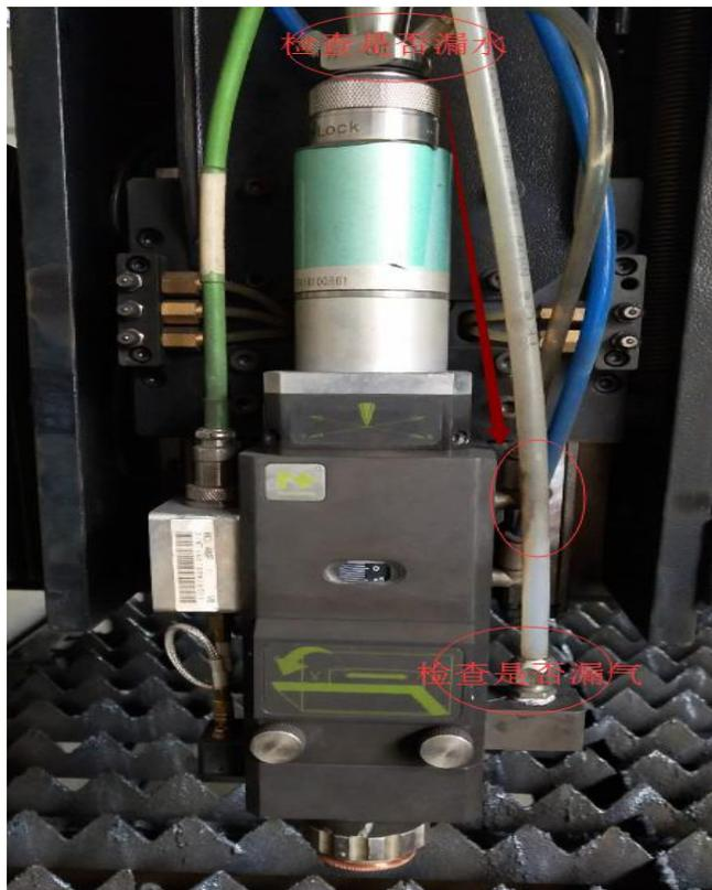
图 8. 吹扫 Z 轴光电限位开关
