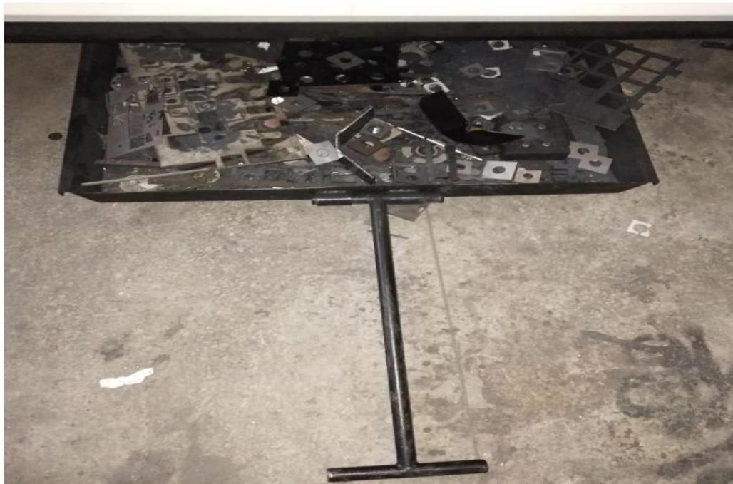
图 3. 清理交换台导轨上的碎铁屑
