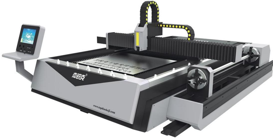
GF-3015 A80 管板一体光纤激光切割机
